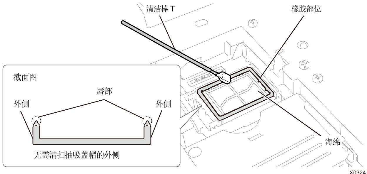
(2) 将清洁棒 T 更换为清洁棒 R，冲洗清洗杯，清扫彩色侧打印头的喷嘴护板。
