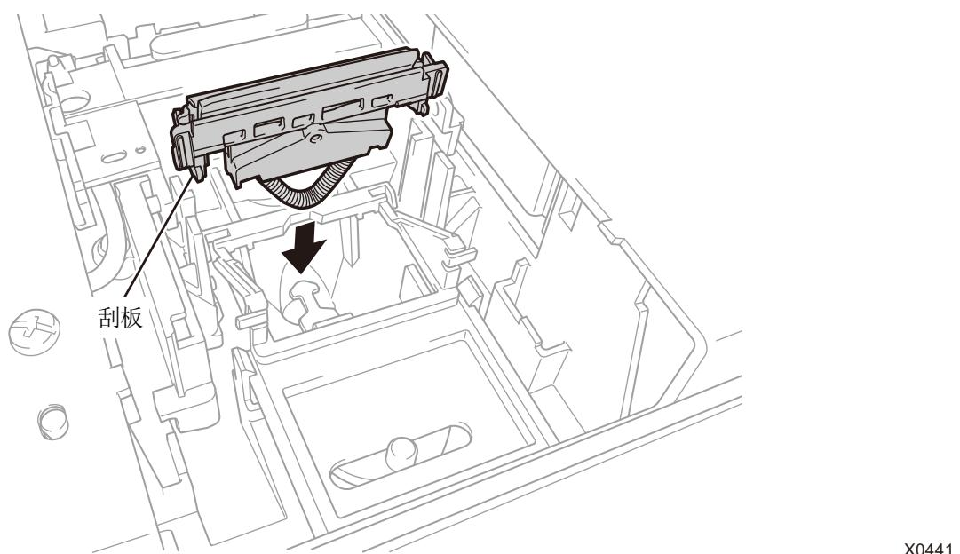
(10) 将刮板下侧的弹簧挂到维护模块的卡子上。
